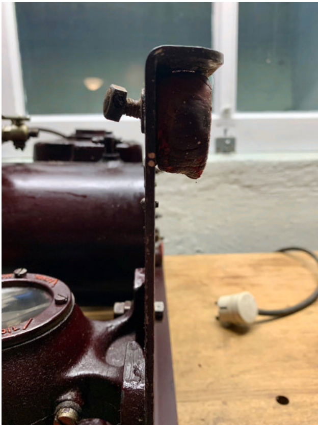
Foto van de voet die helemaal verteerd en ingezakt is. 1 sept. 2025 Compressormotor. Het kijkvenster verwijderd en de harde pakking nog tegen het gietijzer. Deze pakking verwijderd en nieuwe pakkingen gemaakt. Foto's 1 sept. 2025. Rechts: de kranen gangbaar en schoon gemaakt. Onderaan de ontluuchtingskraan.
