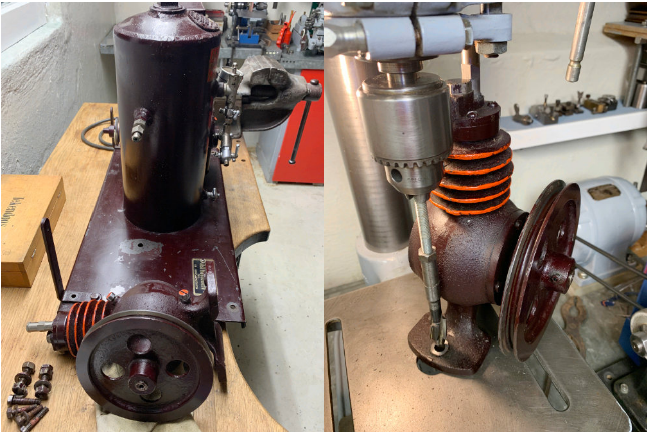
De compressormotor losgeschroefd zodat de verbindingbuis vrij kwam. 3 sept. 2025. Rechts: het ruwe oppervlak van de flens vlak gefreesd aan beide kanten. 5 sept. 2025.
