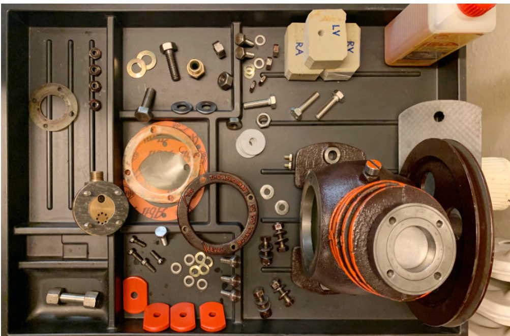
De cilinder en zuiger, diameter 1 inch (25,4 mm) schoongemaakt. Nieuwe pakking aangepast op de klepopeningen. 9 sept. 2025.
