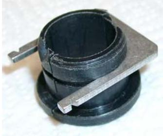
Anschließend wird mit einem Bügel von der Getriebeseite her die Buchse axial gesichert.
