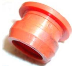
Die hintere Buchse zur Führung der Schaltstange hatte sich 2-geteilt und hing nur noch funktionslos auf der Stange. Das Schalten ging zwar noch leidlich, aber es schepperte beim Fahren doch recht deutlich aus dem hinteren Wagenteil.
