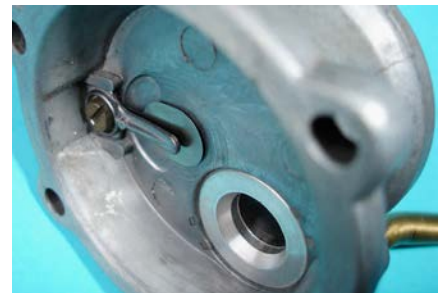
Metalen klep sluit niet meer goed af, pompdruk wordt niet meer gehaald.
