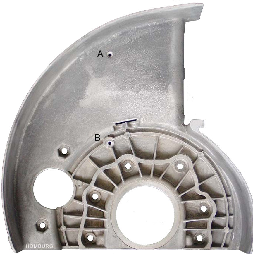
Foto Koppelingshuis aanzicht linker buitenkant. Gewicht 1670 gram. A en B zijn de gaten waardoor de koelluchtplaat wordt vastgeklonken. De klinkverbinding bij B mag niet te veel uitsteken, het vliegwiel draait er vlak langs.
