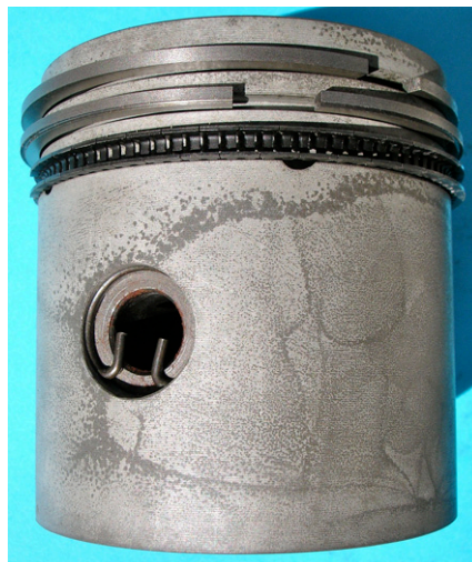
Zuiger NSU 1000 met de borgveren en zuigerpen. Controleer nauwkeurig of de borgveren goed in de groeven geklemd zitten.
