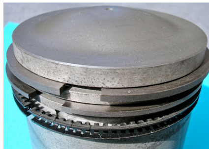
Zuiger NSU 1000, alleen de middelste compressie-olieschraapveer heeft de TOP markering.
