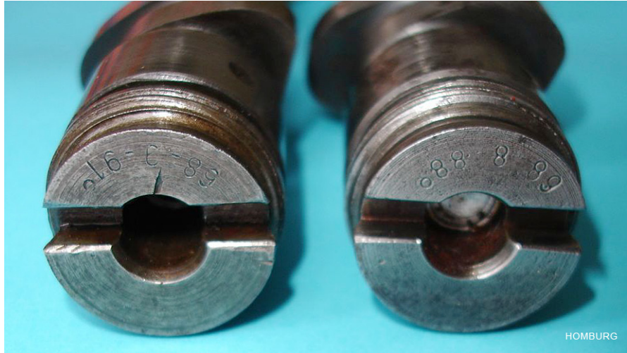
Nokkenas 1000 zonder centrale aluminium olieplug (ontbreekt = defect) en rechts een TTS nokkenas met de olieplug
