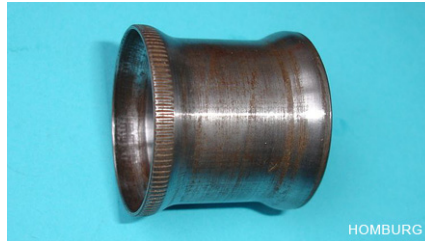
Stalen bus in uitlaatkanaal 1000
