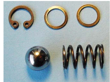
Foto Onderdelen stroomregelventiel TT zekeringsring, vulring, kogel en drukveer.
