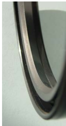
Foto Oliekeerring 65 x 80 x 10 open zijde richting carterhuis monteren. Vet de buitenkant van de keerring en de vatting van het koppelingshuis licht in bij montage in het koppelingshuis.
