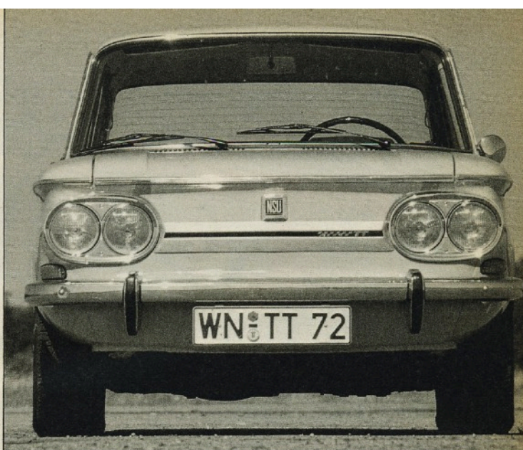
Charakteristische NSU TT-Merkmale: Umlaufende Sicke und Doppelscheinwerfer (oben). Ölkühler in der linken Heckseite (links). Sachliche, aber nicht blendfreie Rundinstrumente (unten).
